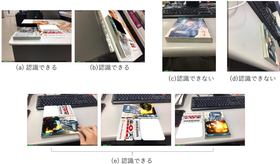
図 3.14 被写体を斜めや回転させて撮影した場合の認識結果
