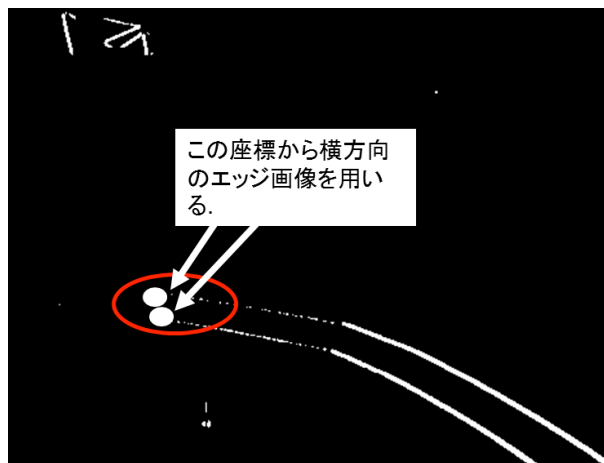
図 22 車線が横に伸びたため, 車線検出に失敗した例
