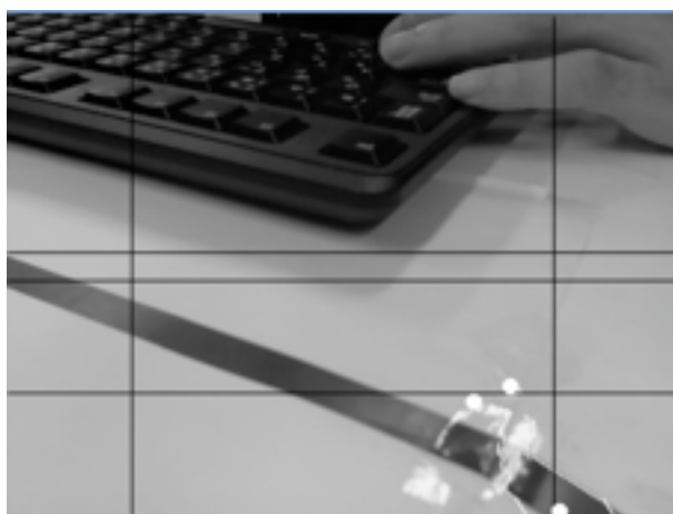
図 26 鏡面反射が原因で車線検出に失敗した例
