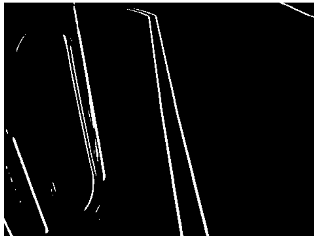
図 20 車線検出に失敗した時のエッジ画像(二値画像)
