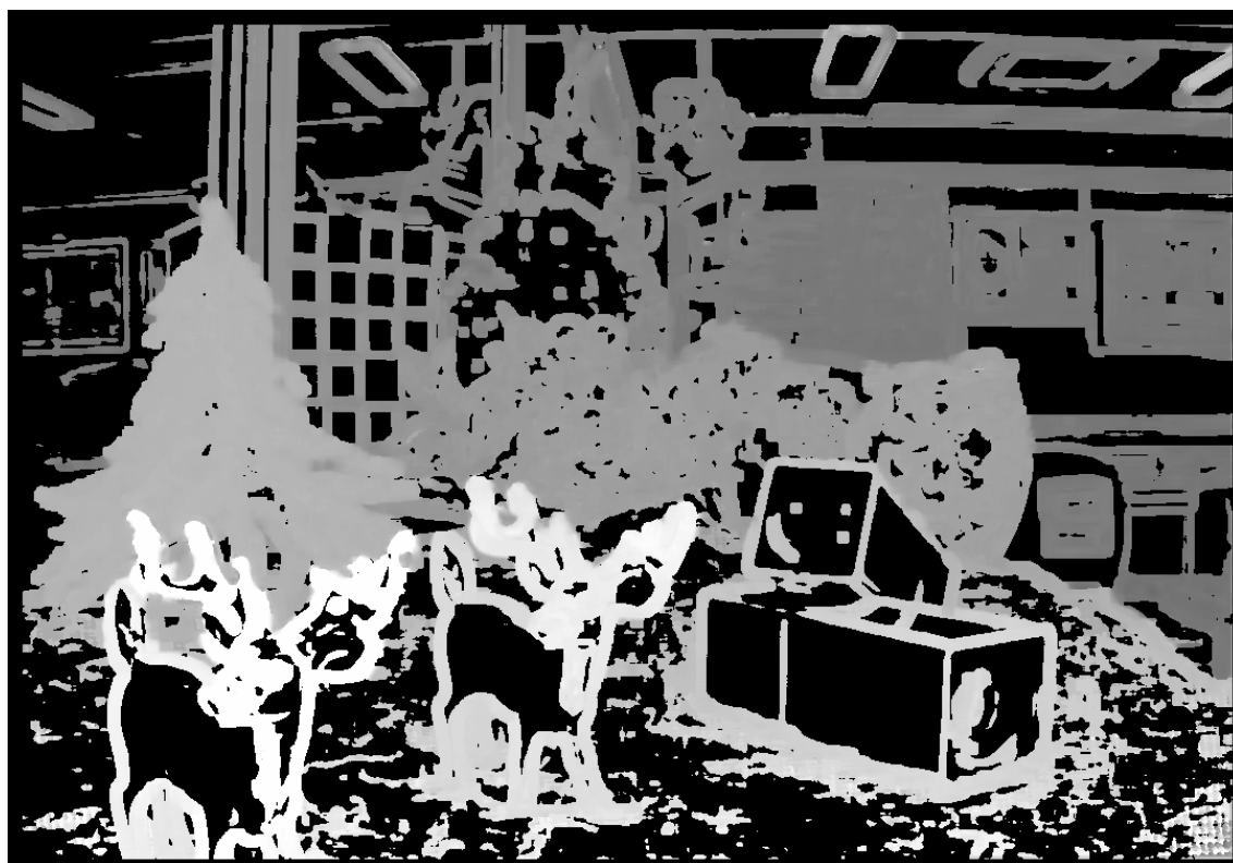
図 2.4 マルチベースライン法で生成した視差画像の例
