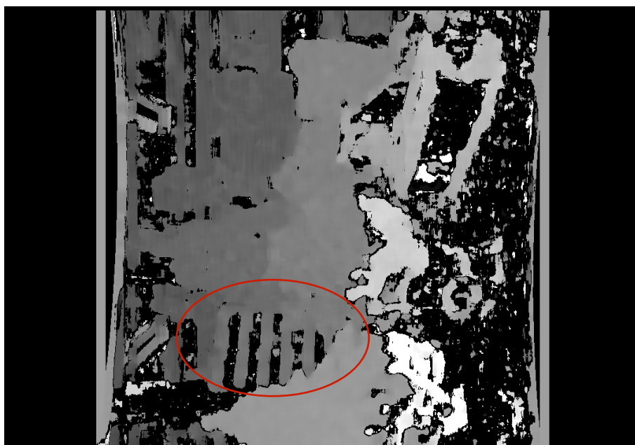
図 4.12 図 4.7 と図 4.8 から求めた視差画像
