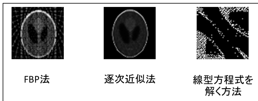
図 5.43 投影回数を 14 回に設定した場合における従来手法の再構成画像
