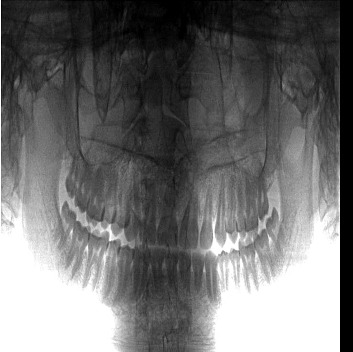
図 6.1 FPS の 15 列目が生成する X 線パノラマ画像(規定位置の場合)
