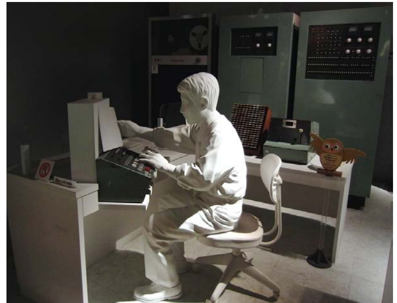
国鉄の座席予約システムMARS101、本体側のコンピュータはHITAC3030
