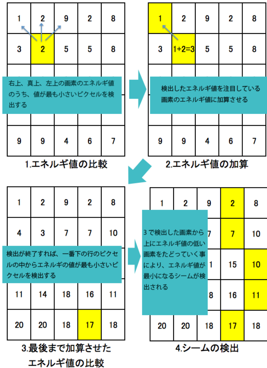
図 25 動的計画法によるシームの検出
