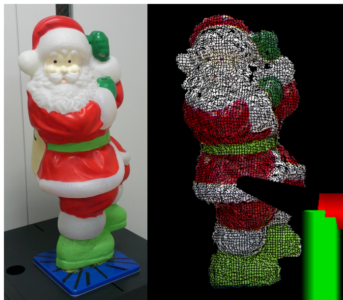
図 2.1 Kinect で撮影した立体物と 3次元点群データ
