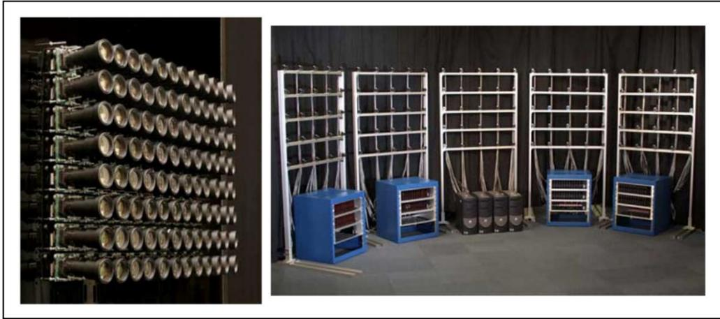
図 1.2 スタンフォード大学のカメラアレイ方式によるライトフィールドカメラ
